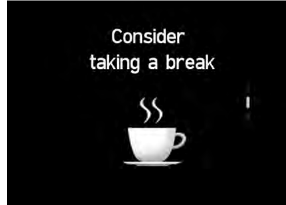
System monitorujący poziom koncentracji uwagi kierowcy (DAW) Po zidentyfikowaniu wzorca zmęczenia lub nieuwagi system zwraca uwagę kierowcy za pomocą sygnału ostrzegawczego i komunikatu na wyświetlaczu, sugerując przerwę.
