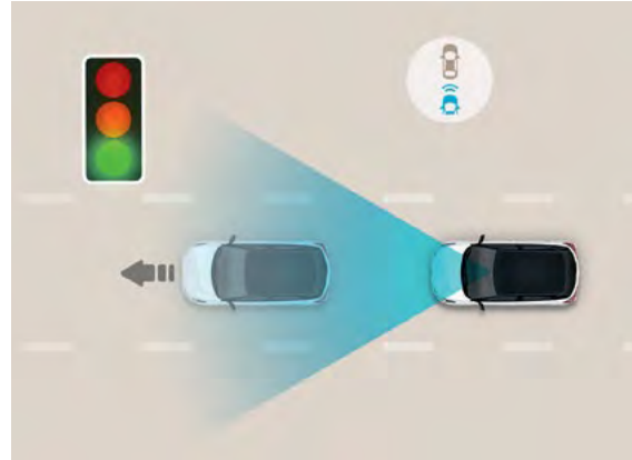
System ostrzegający o odjechaniu poprzedzającego pojazdu (LVDA) Ta inteligentna funkcja podczas jazdy po mieście powiadamia kierowcę, gdy pojazd z przodu rusza, na przykład na światłach lub w korku.
