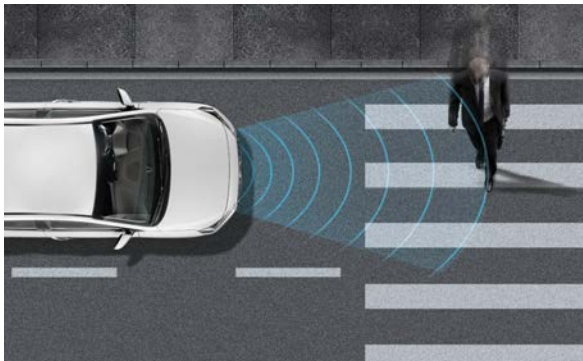
System unikania zderzenia czołowego (FCA) Obserwujący drogę za pomocą radaru i kamery system FCA ostrzega, a następnie automatycznie hamuje po wykryciu nagłego hamowania pojazdu jadącego z przodu. System wykrywa również pieszych i rowerzystów.
