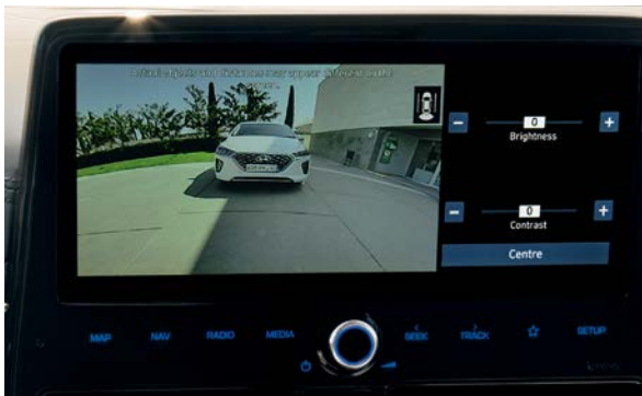
DRM (Monitorowanie widoku do tyłu) Nowy system DRM wykorzystuje kamerę, która pokazuje wyraźny obraz sytuacji za pojazdem – dzięki czemu jazda jest przyjemniejsza i bezpieczniejsza.
