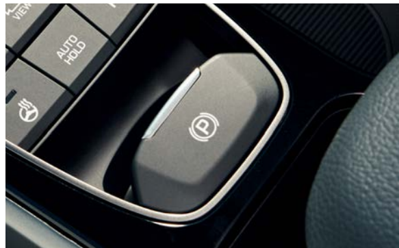
Elektryczny hamulec postojowy (EPB) Sterowanie jednym palcem. Hamulec postojowy włącza się i wyłącza jednym naciśnięciem przycisku we wszystkich trzech modelach IONIQ. Takie rozwiązanie nie zajmuje też cennego miejsca w konsoli środkowej, na której umieszczono praktyczną ładowarkę bezprzewodową.
