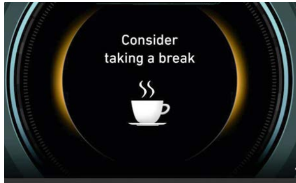
Monitorowanie poziomu uwagi kierowcy (DAW) Po zidentyfikowaniu wzorca zmęczenia lub nieuwagi system zwraca uwagę kierowcy za pomocą sygnału ostrzegawczego i komunikatu na wyświetlaczu, sugerując przerwę, pasem ruchu i w razie potrzeby zmienia światła drogowe na mijania.
