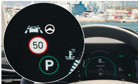
Inteligentne ostrzeganie o ograniczeniu prędkości (ISLW) Funkcja rozpoznaje znaki drogowe, by wyświetlać ograniczenia prędkości i zakaz wyprzedzania na wyświetlaczu systemu nawigacyjnego, jak i zestawie wskaźników.
