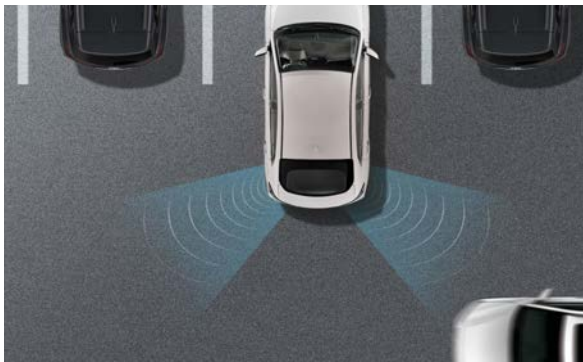
Ostrzeganie przed zderzeniem bocznym przy cofaniu (RCCW) System monitoruje przy użyciu radaru obszar za samochodem i ostrzega kierowcę wizualnie i dźwiękowo o nadjeżdżających pojazdach.
