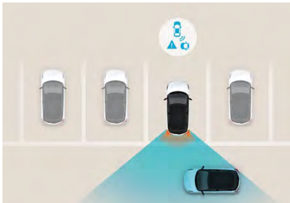
Asystent zapobiegania kolizjom z pojazdami podczas cofania (RCCA) Przy cofaniu w miejscach o ograniczonej widoczności system ostrzega przed pojazdami przejeżdżającymi z tyłu, a w razie konieczności automatycznie uruchamia hamulce.
