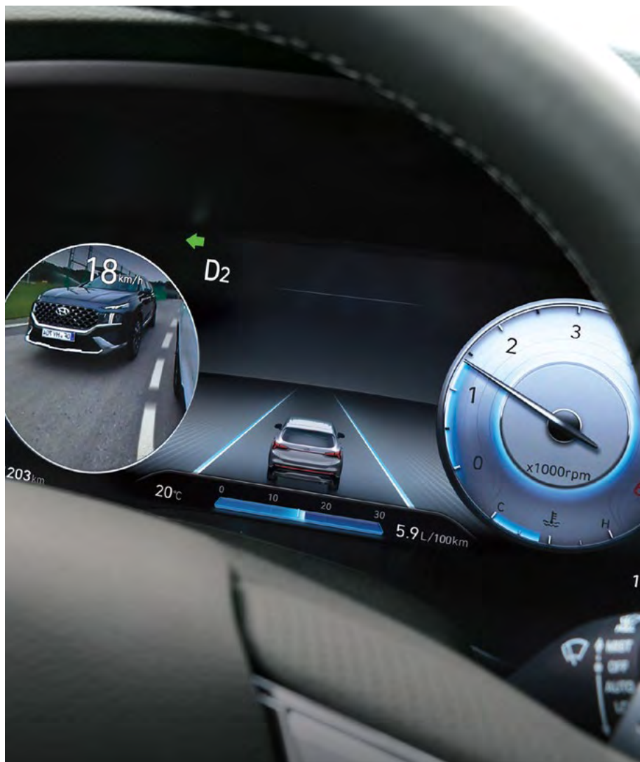
Monitorowanie martwego pola na cyfrowym zestawie wskaźników 12,3".
