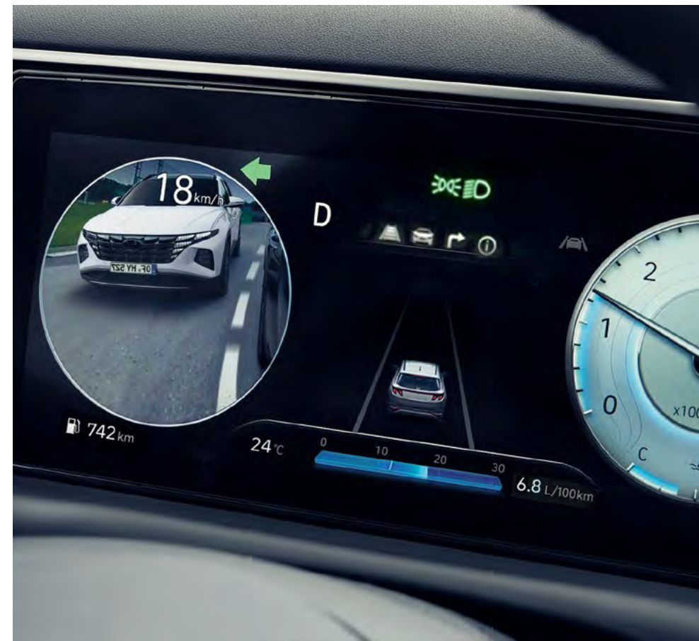
System wyświetlający widok z martwego pola (BVM) Zmienianie pasów ruchu nigdy nie było łatwiejsze i bezpieczniejsze. Teraz możesz obserwować martwe pole z tyłu z lewej i prawej strony na ekranie w cyfrowym zestawie wskaźników. Kamery są aktywowane w chwili włączenia kierunkowskazu.
