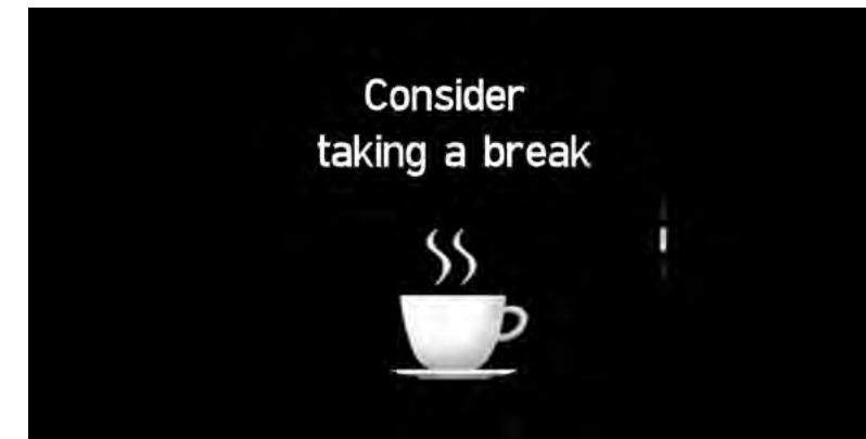
System monitorujący poziom koncentracji uwagi kierowcy (DAW) Po zidentyfikowaniu wzorca zmęczenia lub nieuwagi system zwraca uwagę kierowcy za pomocą sygnału ostrzegawczego i komunikatu na wyświetlaczu, sugerując przerwę.
