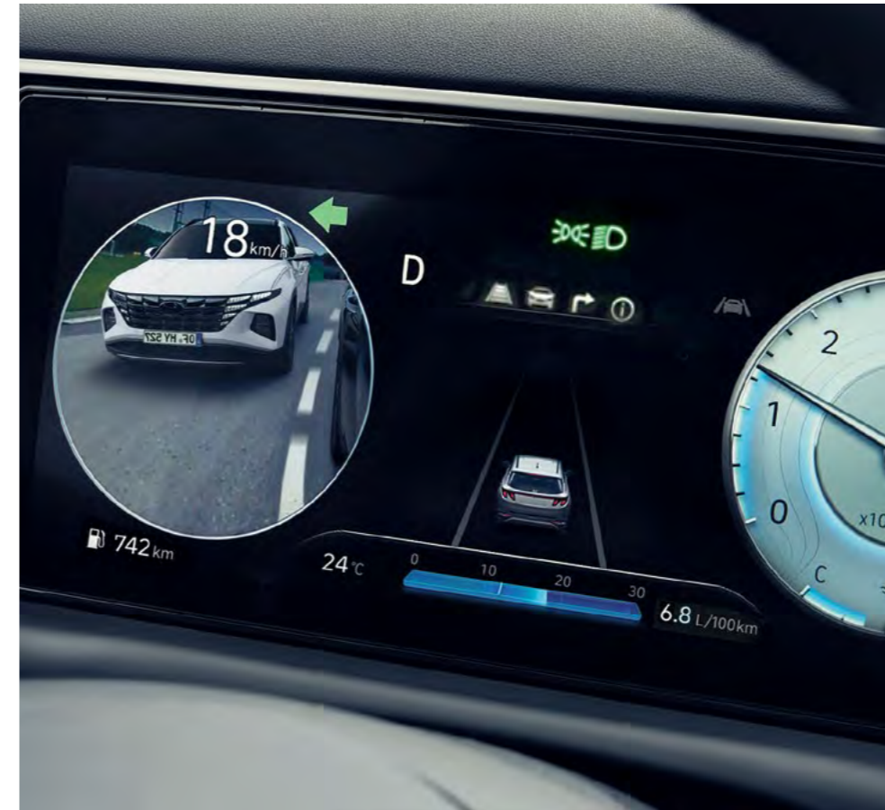
System wyświetlający widok z martwego pola (BVM) Zmianianie pasów ruchu nigdy nie było łatwiejsze i bezpieczniejsze. Teraz możesz obserwować martwe pole z tyłu z lewej i prawej strony na ekranie w cyfrowym zestawie wskaźników. Kamery są aktywowane w chwili włączenia kierunkowskazu.
