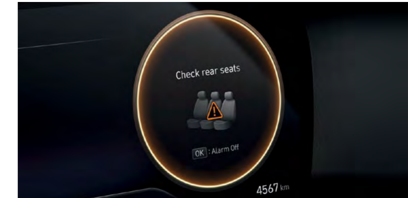
System monitorowania tylnej kanapy (RSA) Czujniki ultradźwiękowe wykrywają ruch pasażerów z tyłu, a system powiadamia kierowcę o przypadkowym pozostawieniu dzieci lub zwierząt.
